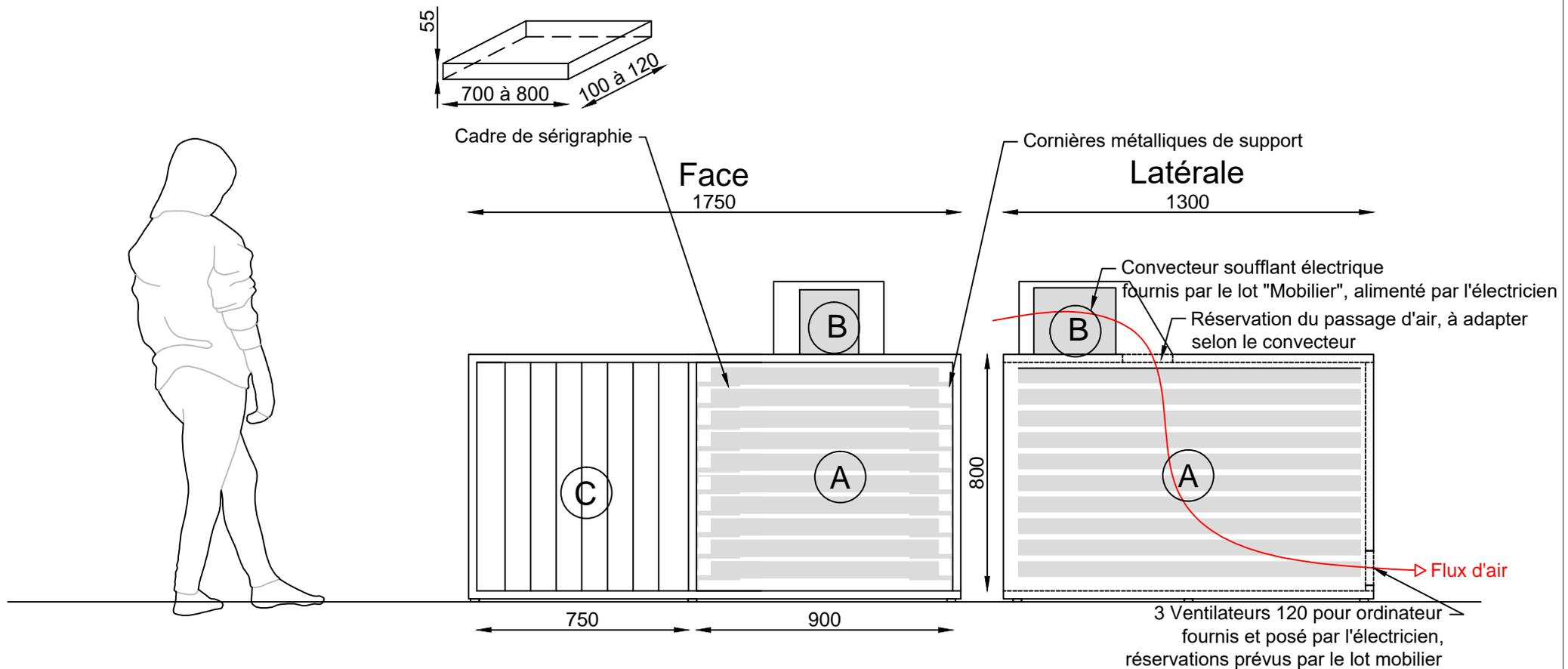
Outil pour la sérigraphie, ce meuble permet de sécher rapidement les cadres. Les cadres sont posés sur des cornières métallique dans l'enceinte (A) qui est alimenté en air chaud depuis la partie (B) à l'aide d'un convecteur électrique
