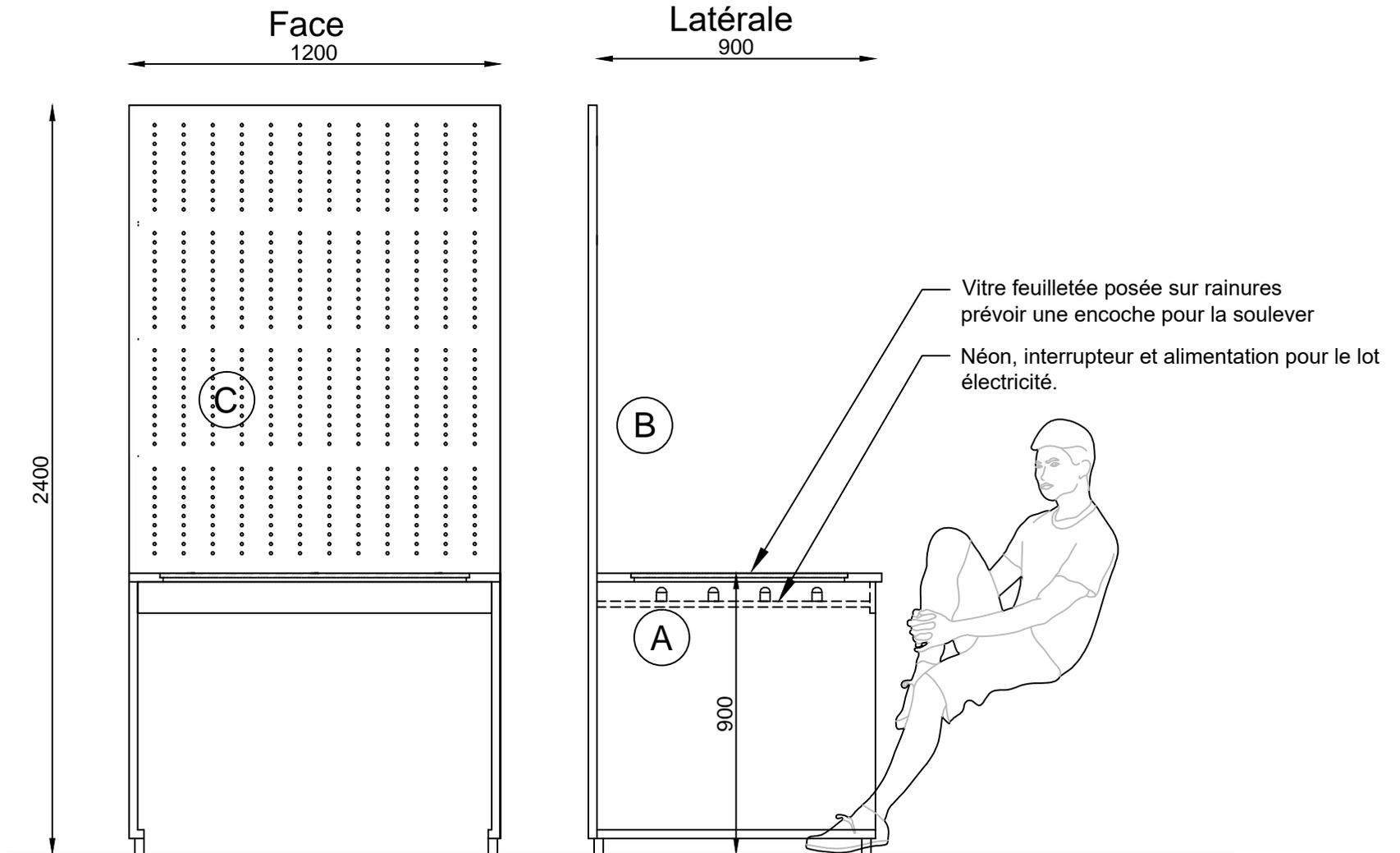
Ce meuble est un module de l'un des deux ensembles composant les plans de travail des ateliers. Celui-ci est équipé d'un plan de travail intégrant une table lumineuse (A). La partie haute est composée d'un panneau et de crémaillère (C) sur lesquels viendront se fixer des modules d'étagères (B).
