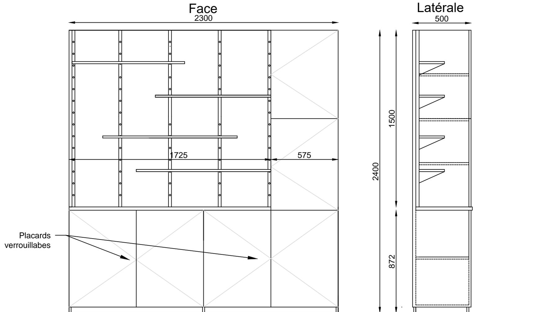
Ce meuble est composé d'un ensemble de portes de placards fermant à clé. Il sera utilisé pour stocker le matériel nécessaire à la sérigraphie.
