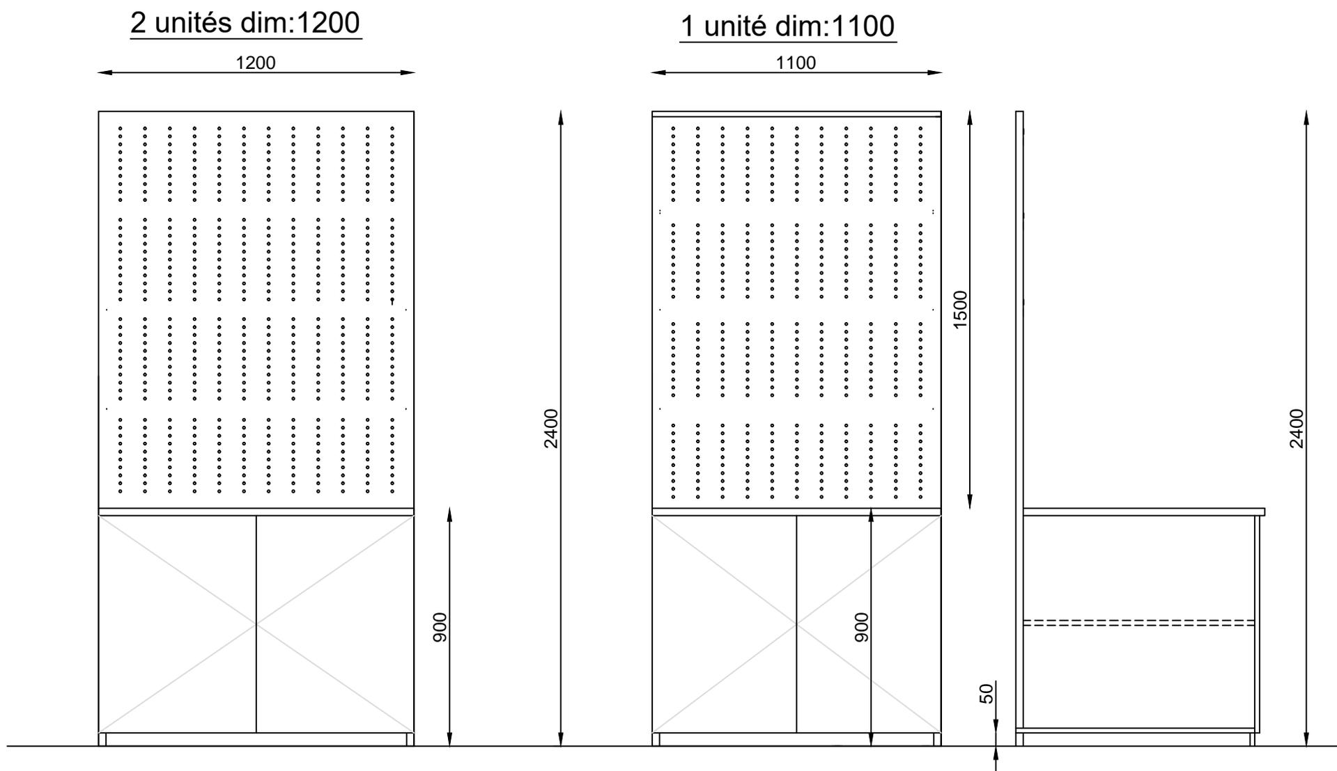
Ce meuble est un module de l'un des deux ensembles composant les plans de travail des ateliers. Celui-ci est un plan de travail équipé d'un placard fermant à clé. La partie haute, comme les autres meubles, est formé de rails pour supporter des modules étagères/outils/...
